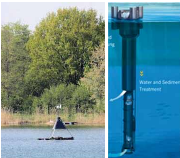
Figur 10: Anlegg for fosforfjerning fra bunnvannet (venstre), drives med solpaneler. Hypolimnisk luftbobling (høyre) kan også kobles med fosforfjerning. Det kan tilføres jern til bunnen i begge typer anlegg.
