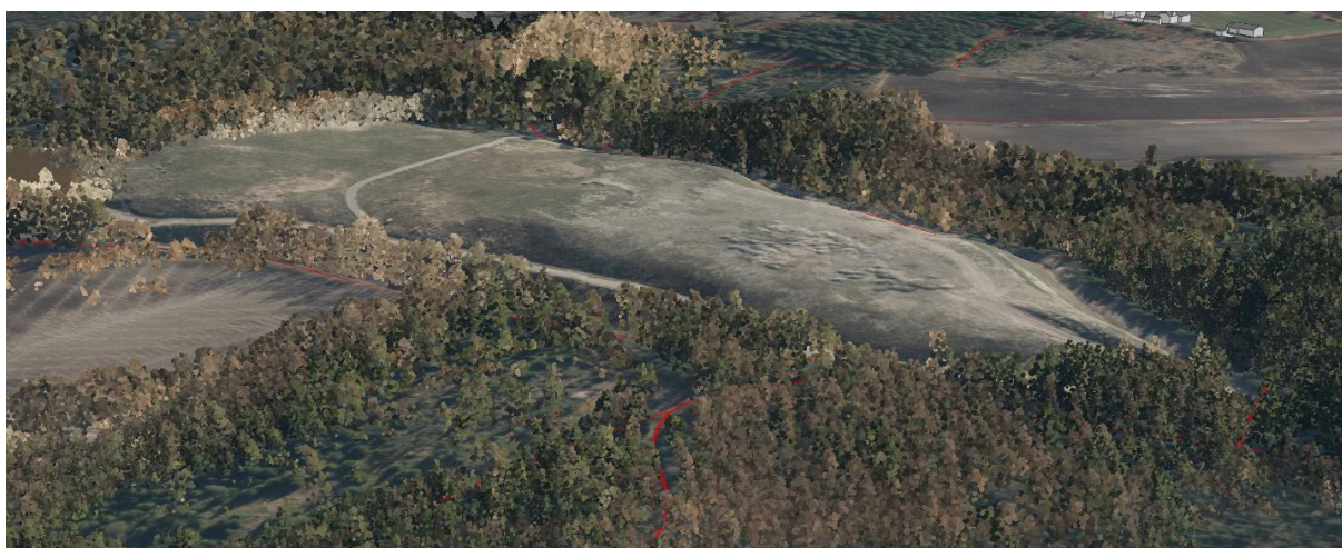
Figur 0-7. Bilde fra GIS-modell (sett fra sørvest) som viser at området er fylt opp mer enn det opprinnelige terrenget før uttak.
