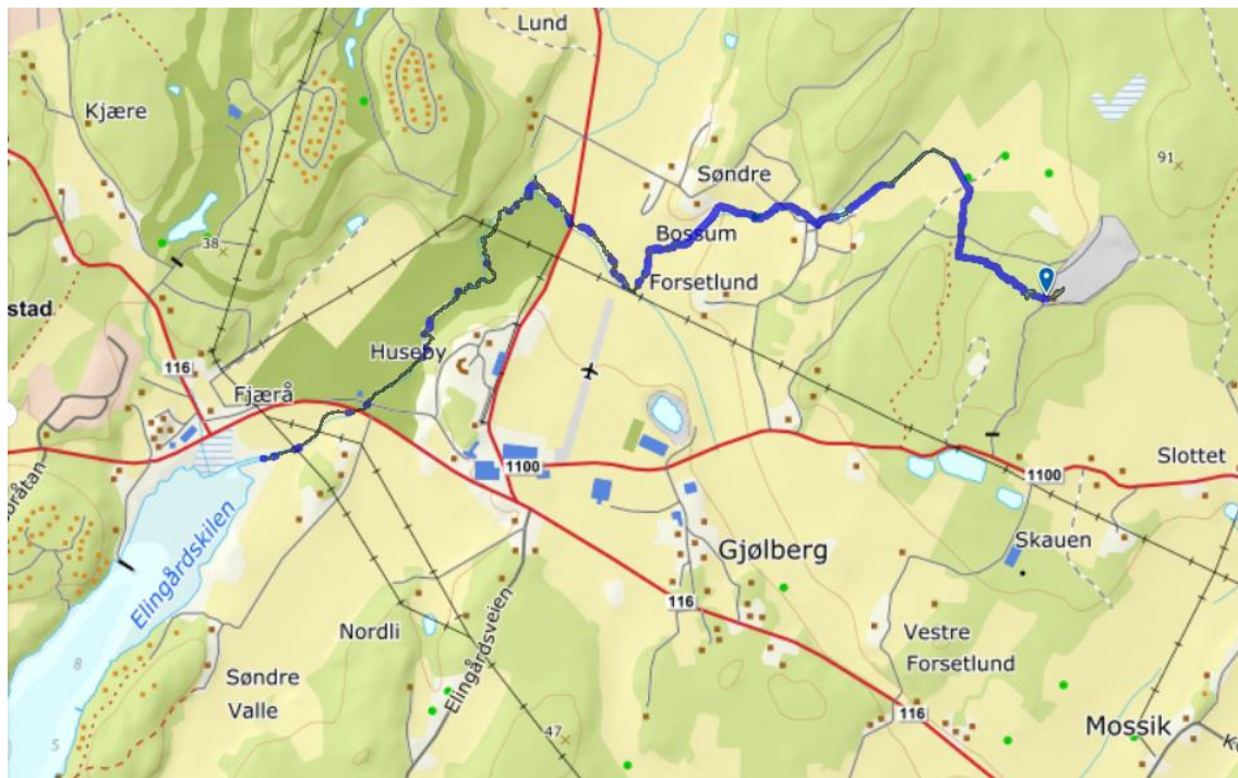
Figur 15-1 Avrenning fra tiltaksområdet mot vest, til vannforekomst «Bekker til Elingårdskilen». Kilde: Scalgo Live.
