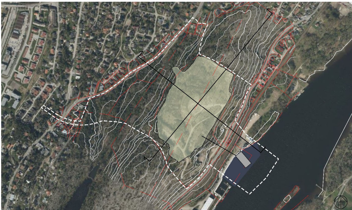
Illustrasjon av hvordan terrenget i det gamle steinbruddet kan tilbakefylles og formes slik at det harmonerer med omgivelsene. Den hvite stipla linja er forslag til plangrense.
