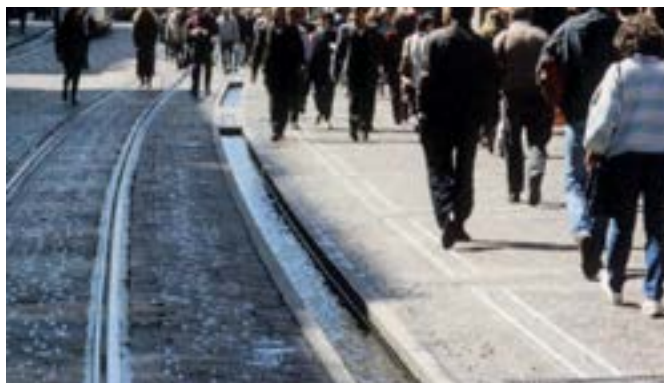
Illustrasjon 16: Åpen overvannshåndtering som gatesonering.
