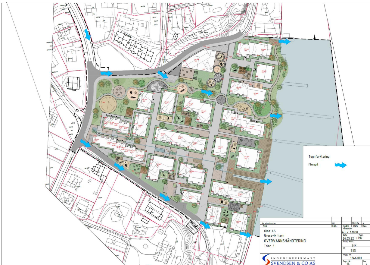
Fig 17 – Fallretning for overvann som flomveier
