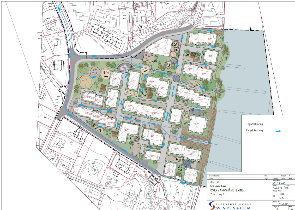
Fig 16 – Fallretninger for overvann angitt med piler
