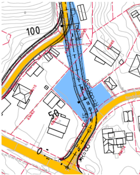
Figur 6-1 Utklippet viser forslaget til anleggsvei via Sandklova, men det er valgt å benytte Stenbukta. (Kilde: Sweco Norge AS)
