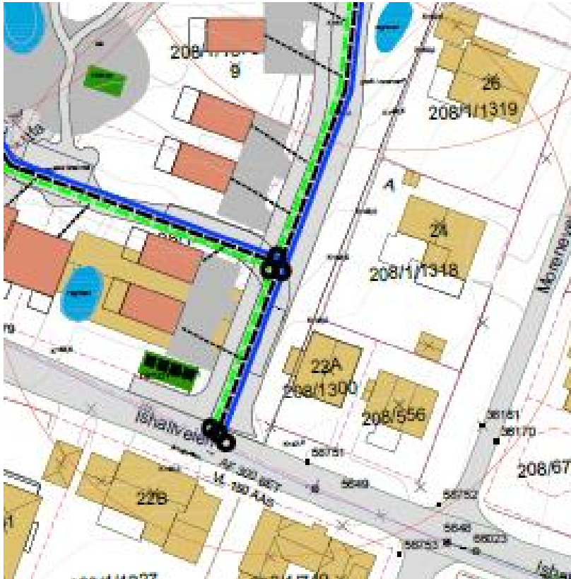
Figur 4: VA-anlegg tilknyttes eksisterende nett i Ishallveien.
