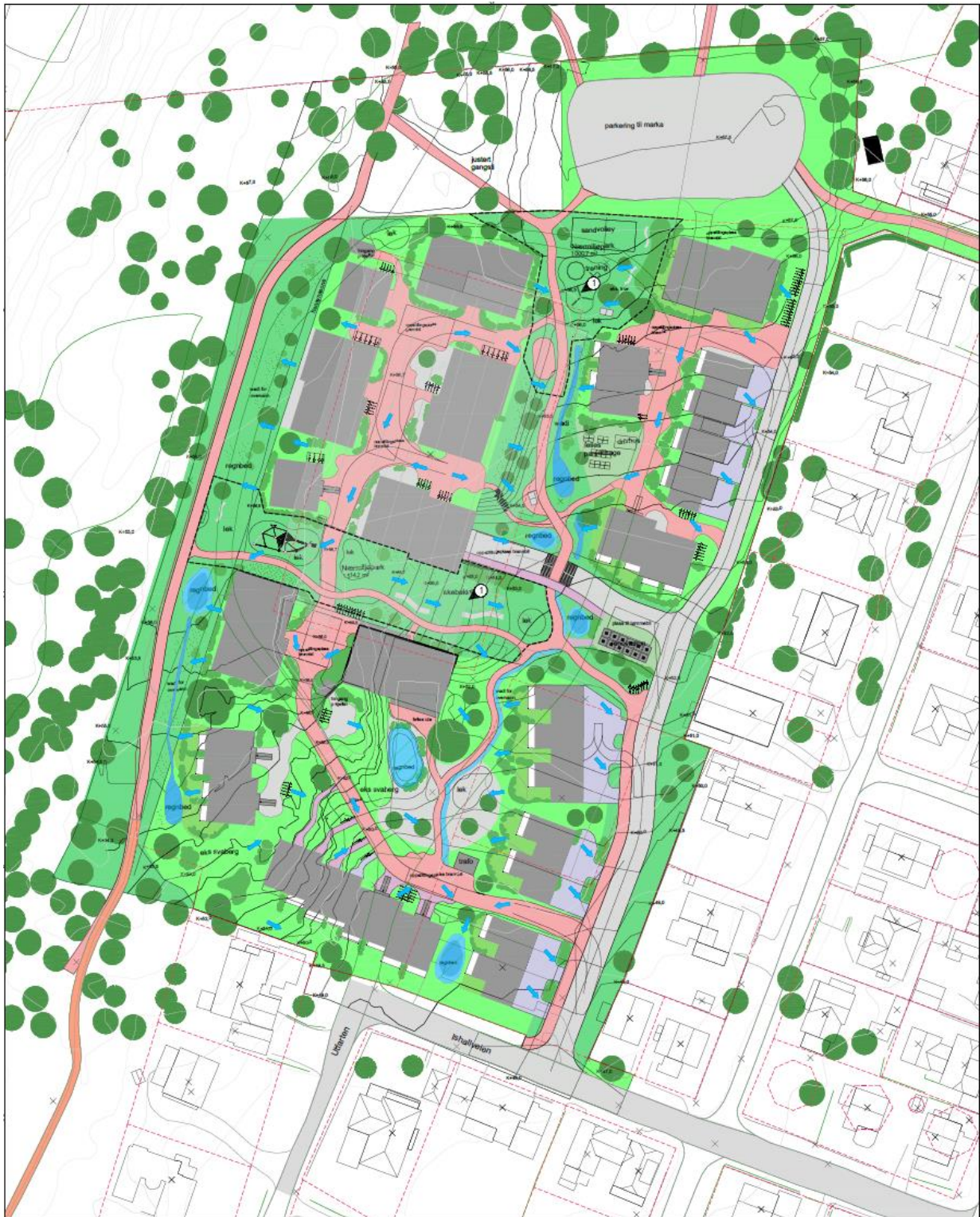
Fig 17 – Fallretninger for overvann angitt med piler
