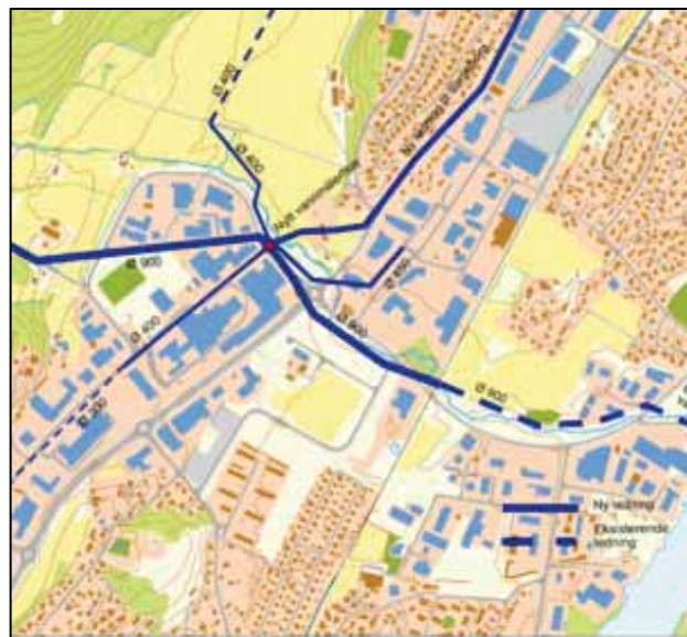
Figur 15. Ringledning for vann, etappen vannverket – Råbekken.
