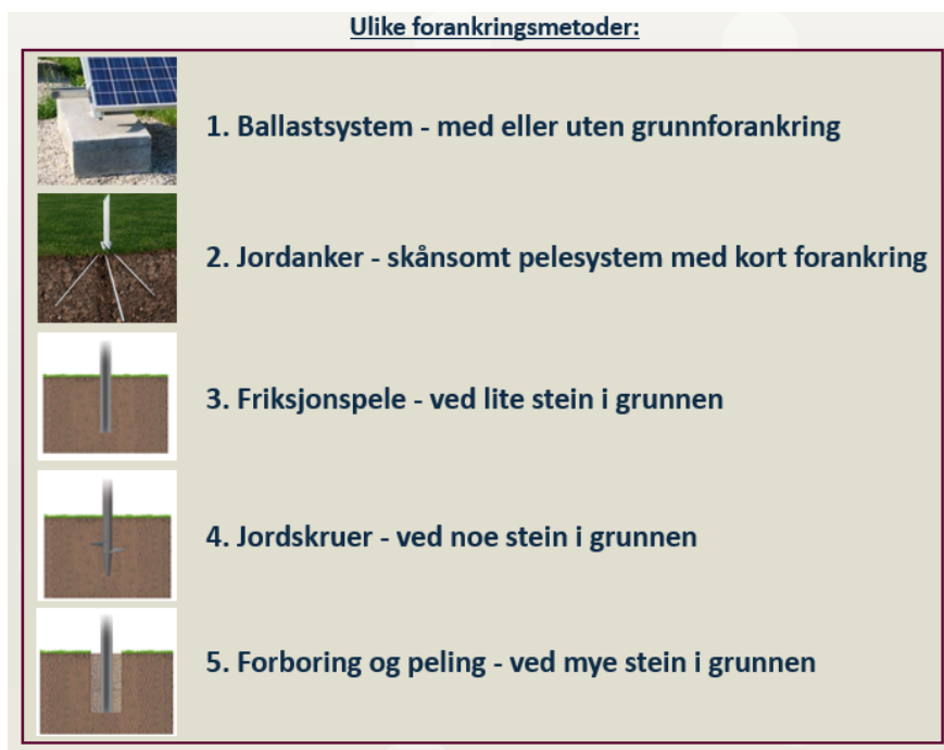
Figur 9. Ulike forankringsmetoder for montasjesystemet til bakken
