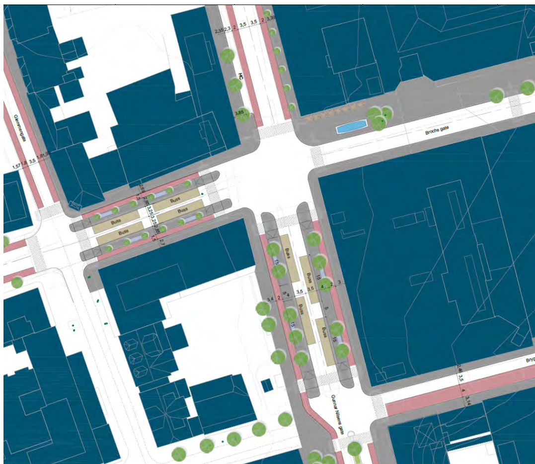
Figur 37: Målsatt plantegning av en av flere mulige løsninger for nytt kollektivknutepunkt.
