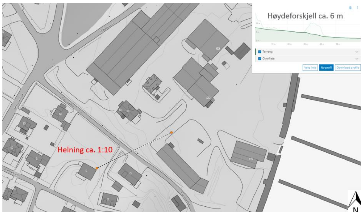
Figur 3-4: Bratteste helning er ca. 1:10 ned fra det påviste berget i Gressvik allé 3 [hoydedata.no].
