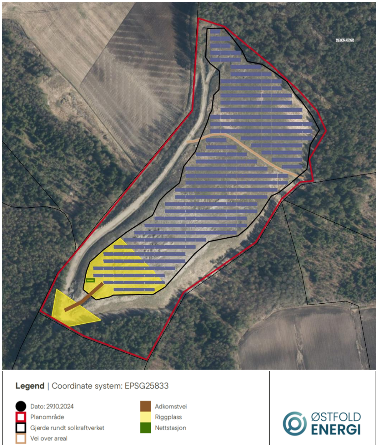
Figur 6: Oversiktsbilde av Forsetlundgropa Solkraftverk. Plasseringen av solcellemoduler vises tydeligere i terrenget. Se spesielt på avgrensning mot skogen i nord,
