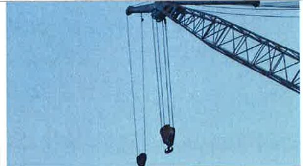
Krok blokker. Kroken til høre løfte kapasitet 50 tonn.
