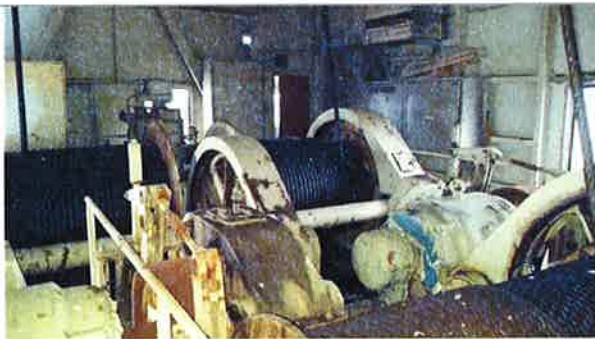
Maskin rom innside. Ser tilsynelatende bra, men alle lager, gir, bremser, er fast rustet.
