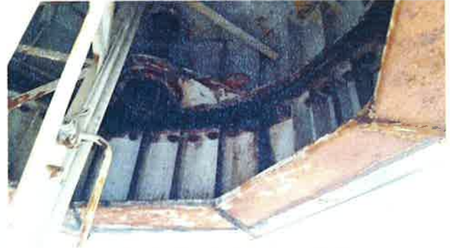
Bildet er tatt fra undersiden av maskinhus, og viser sving kransen og undersiden av sving gear.
