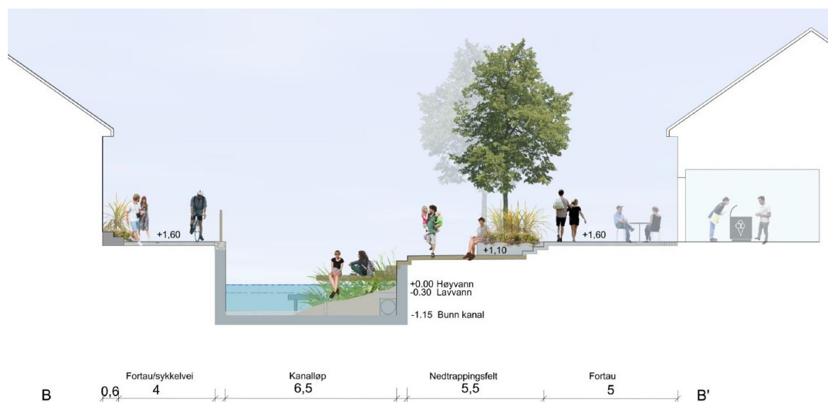
Figur 2: Illustrasjonssnitt som viser bredder langs kanalen i kvartalene mellom Borggata og Huths gate.
