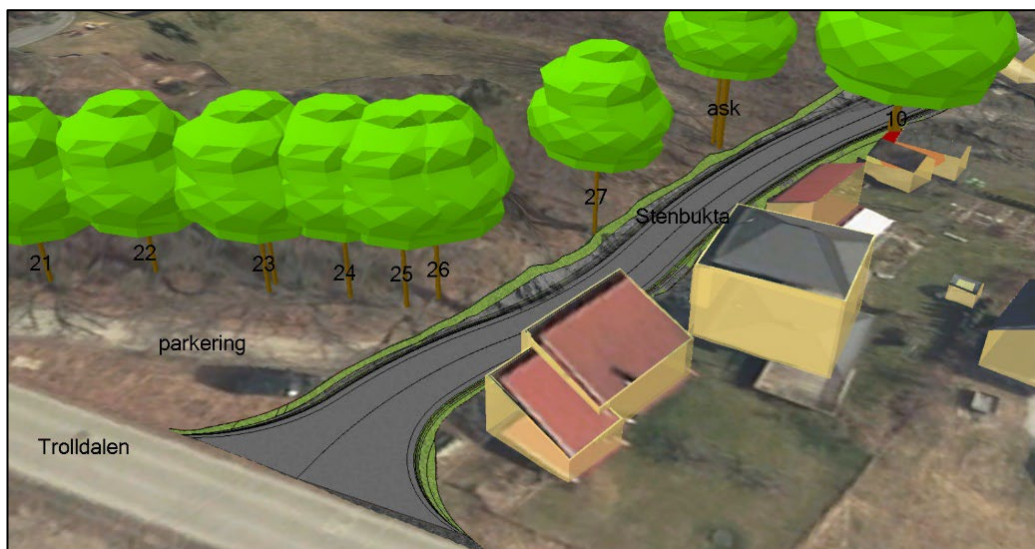
Figur 4-5 Utsnitt fra Smart-modell pr. september 2020 som viser mulig konflikt mellom vernede, gjenværende eiker nr. 25 og 27 ved breddeutvidelse av veien Stenbukta. Eik nr. 24 og 26 er felt etter at utsnittet ble laget. (Kilde: Sweco Norge AS).
