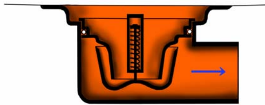
Figuren viser et tverrsnitt av et selvstengende gulvsluk.
